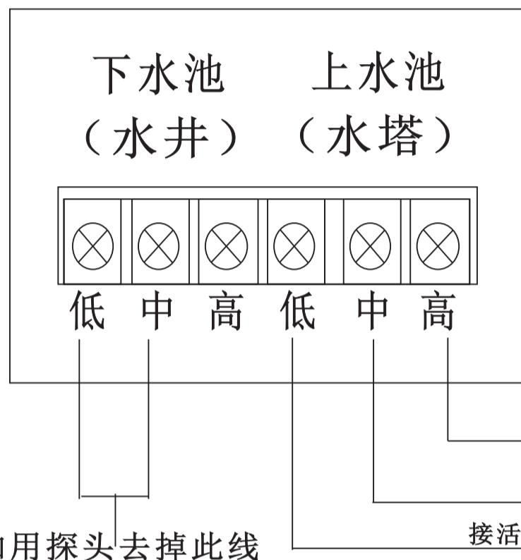
提示：选择压力功能压力绿灯亮即可。上水池的低接公共点；中接起动压力；高接停止压力。即低中连通为起动，低高连通为停止。
