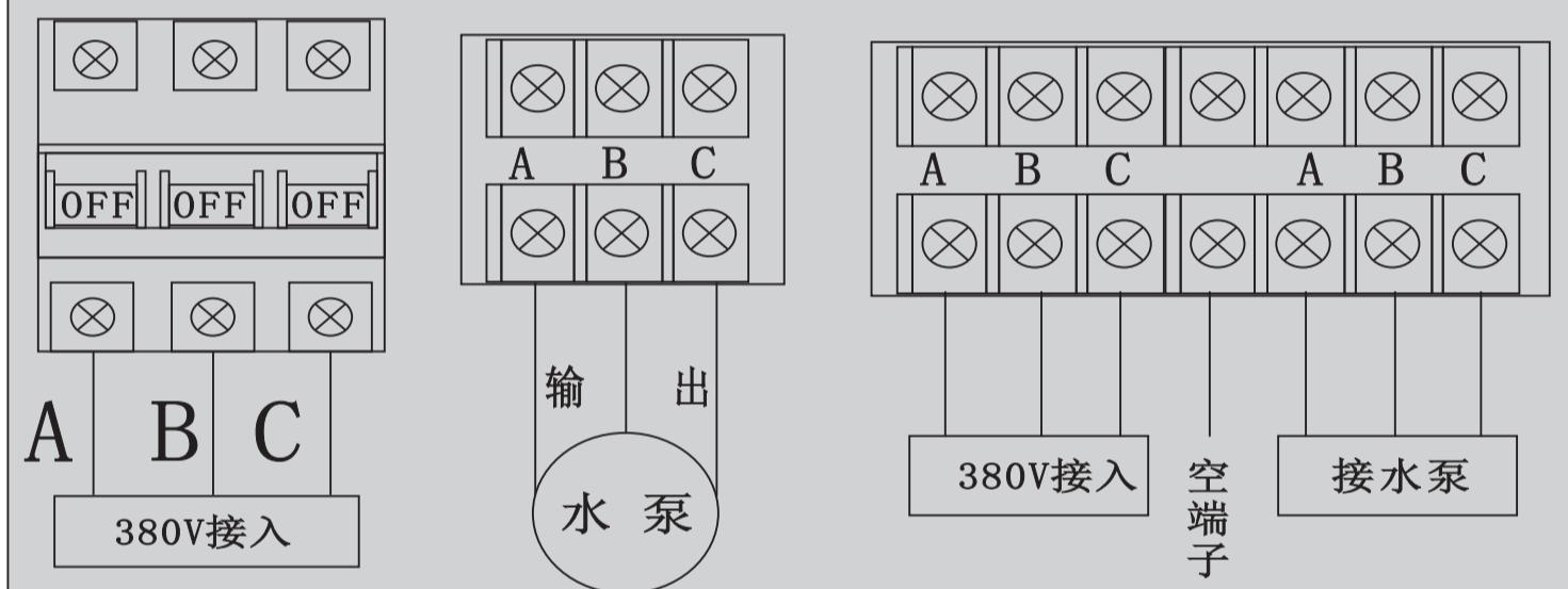
2、根据需求按照下图接好探头线。接线时注意探头线不能短路，不能挨着水池壁；延长讯号线时（建议延长讯号线的截面积不大于 $0.75\text{mm}^2$ ），请用防水胶布确保接驳良好。（如用空载保护，则不能接下水池讯号线）。
