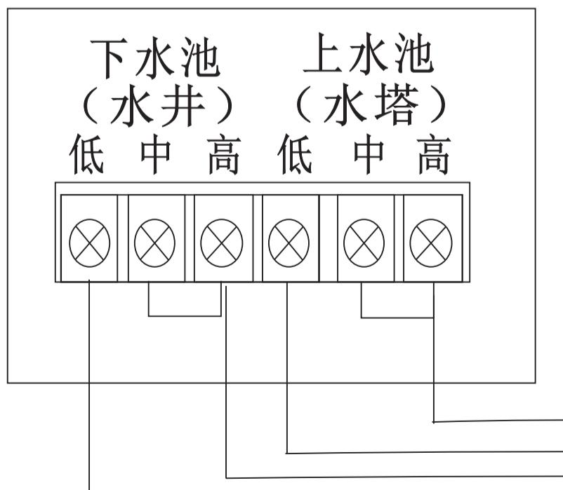
提示：浮球接法时，将水位的中位与高位短路（连接），再将浮球常开的两根线分别接到低位和高位；常闭点不用接即可。
